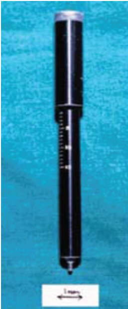
Εικόνα 3. Δερμογραφόμετρο. Η βαθμονομημένη κλίμακα 0 έως 15 είναι ισοδύναμη με εφαρμογή πίεσης στην κεφαλή από 20 έως 160 g/mm 2 .
